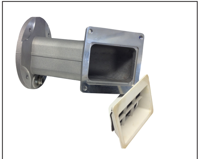
Рисунок: Визуальный контроль обратной заслонки
