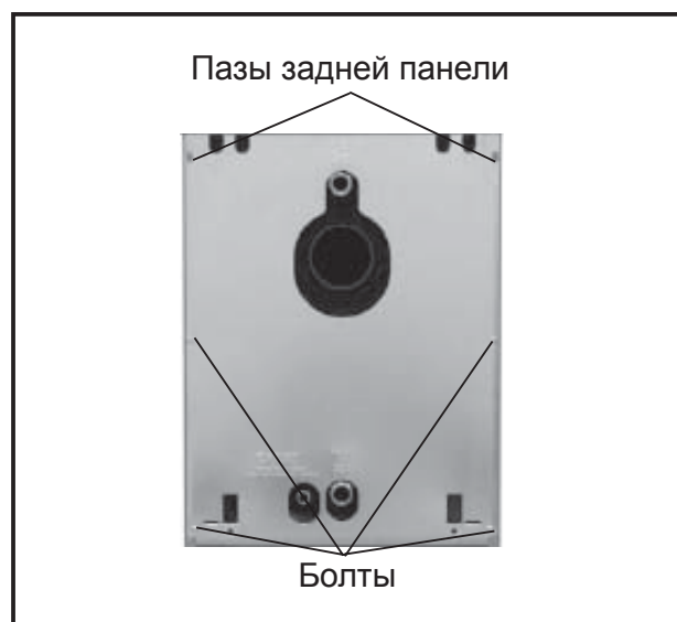
Рис.: Монтаж задней панели
