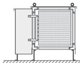
Подсоединения снаружи установки в погодозащищенной консоли с ревизионной дверью. Опционально консоль с изоляцией. (l = в зависимости от конфигурации установки).
