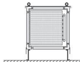
Подсоединения нагревателя внутри установки, патрубки загнуты по или против хода воздуха. Подсоединения охладителя внутри установки, патрубки загнуты против хода воздуха. Подсоединения труб и установка арматуры в пустой секции, расположенной рядом.
