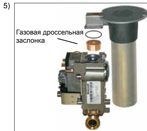
Вынуть встроенную газовую дроссельную заслонку и заменить ее дроссельной заслонкой, предназначенной для нового вида газа (согласно таблице на стр. 56).
