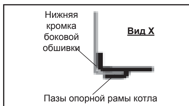
Рис.: Монтаж боковой обшивки
