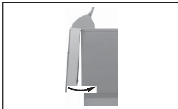
Рис.: Монтаж лицевой обшивки
