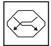
Секция пластинчатого теплообменника с перекрестным движением потоков
