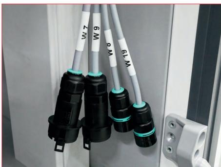
**Выведенные и промаркированные** штекерные соединения значительно упрощают процесс прокладки кабелей.
