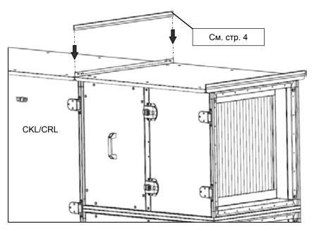
Только в случае CKL**-A**/CRL**-A**: Модуль расширения снизу
