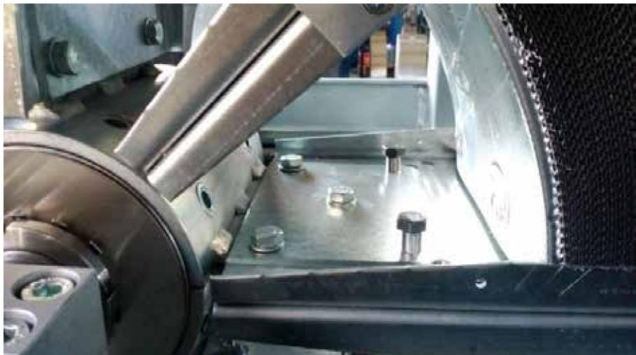
Les vis 4x M6x16 doivent être vissées à fond dans les ouvertures de la pale sur la circonference du rotor.
