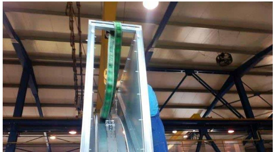
Poser la moitié supérieure du boîtier sur la moitié inférieure du boîtier au moyen d'une grue.
