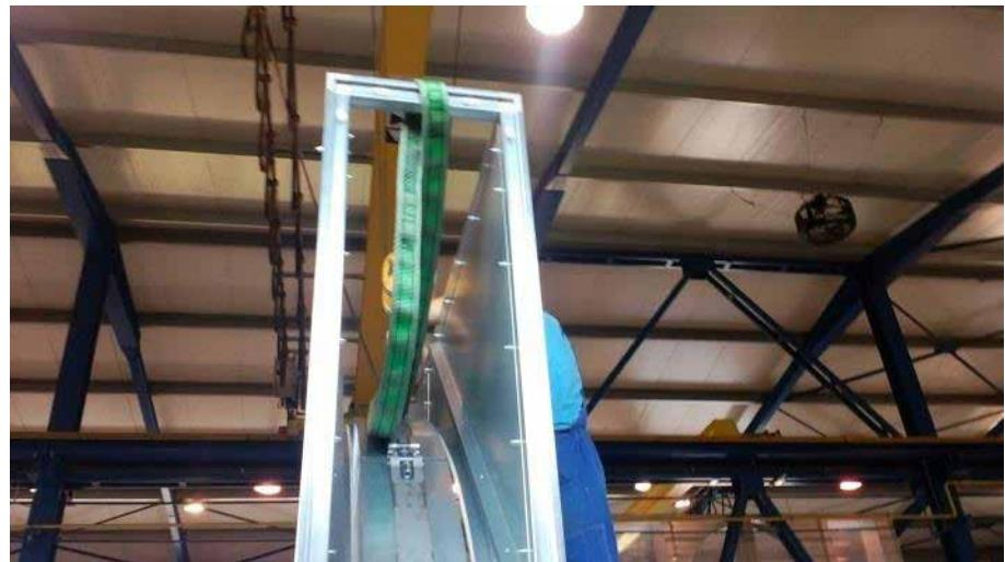
Установить верхнюю половину корпуса на нижнюю половину корпуса.
