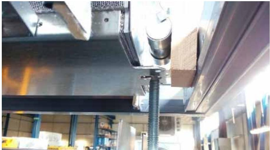
La chapa del revestimiento de la mitad inferior del rotor se debe introducir entre la masa acumuladora y el revestimiento de la mitad superior del rotor.
