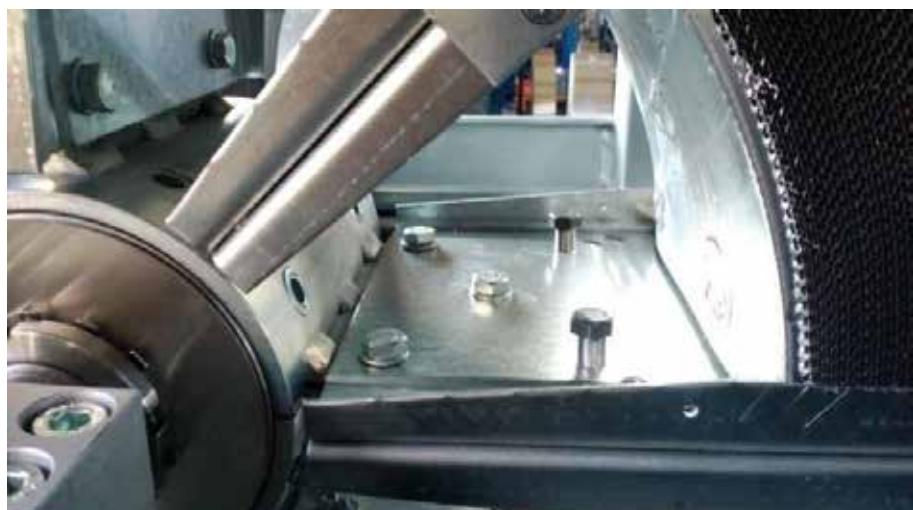
Вставить 4 винта M6x16 в отверстия в листе по окружности ротора и затянуть их.
