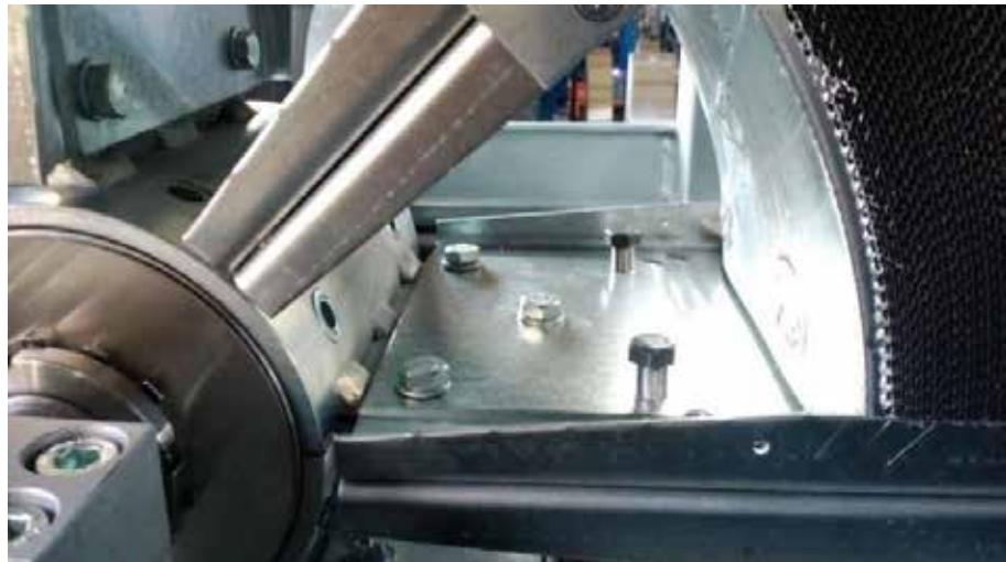
Die Schrauben 4x M6x16 in die Öffnungen im Blatt am Umfang des Rotors einsetzen und festziehen.
