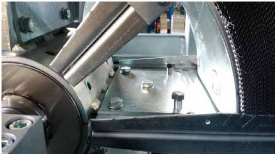
Colocar y apretar los tornillos 4x M6x16 en los orificios de la pala en todo el perímetro del rotor.
