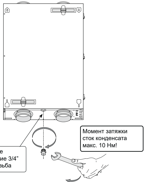
Монтаж стока конденсата установки CWL - F - 150 Excellent (VHZ)
