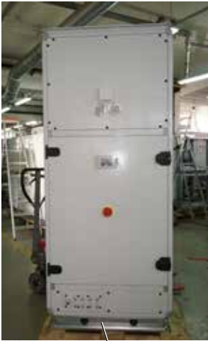
Ввод монтируемых силами пользователя кабелей
