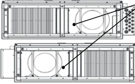
Определение объемного потока производится по методу динамического напора. При этом статическое давление перед впускным соплом сравнивается со статическим давлением во впускном сопле.
