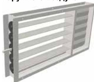
Проверить заслонки на легкость хода. Не смазывать заслонки. Это может привести к разрушению использованной пластмассы, что ведет к неработоспособности заслонки.
