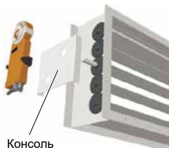
Сервоприводы следует закрепить согласно рисунку с помощью прилагаемой консоли.
