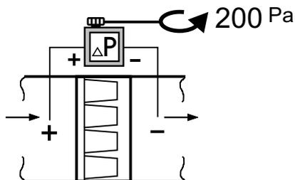
Перед вводом установки CFL-WRG в эксплуатацию дифференциальные реле давления на приточном и вытяжном фильтре необходимо установить на значение 200 Па (с помощью колесика со шкалой).
