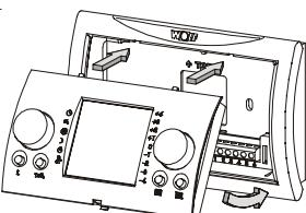
3. Bedienmodul BM in den Wandsockel einclipsen.
