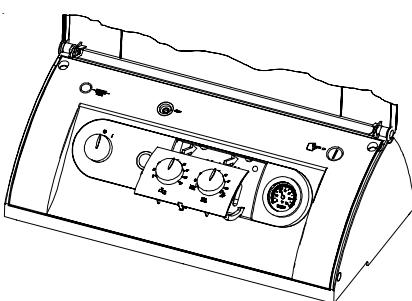
4. Clipser le plastron. Ensuite, enfoncez le commutateur rotatif pour l'eau chaude et celui pour le chauffage avec l'aiguille sur « 5 ». Finalement, tourner avec précaution les commutateurs rotatifs jusqu'en butée à gauche et à droite. S'il est impossible de tourner le commutateur rotatif jusqu'en butée à droite ou à gauche, sortir ce dernier et le tourner de 180°.
