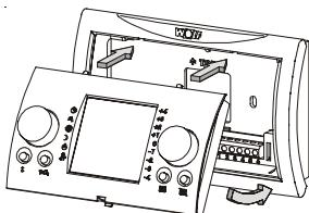
3. Inserire il modulo d'uso BM nello zoccolo a muro utilizzando le clips.
