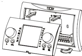
2. Вытащить модуль BM из панели управления котловой автоматики.
