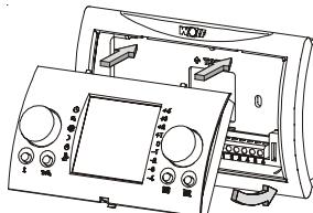
3. Klik de bedieningsmodule BM in de wandsokkel.
