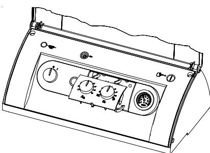
4. Encazar la placa frontal con los clips. A continuación, introducir los mandos de a.c.s. y de calefacción con las marcas señalando la posición "5". Acto seguido, girar los mandos con precaución hasta el tope izquierdo y derecho. Si un mando no se deja girar hasta el tope derecho e izquierdo, hay que sacarlo y girarlo 180°.
