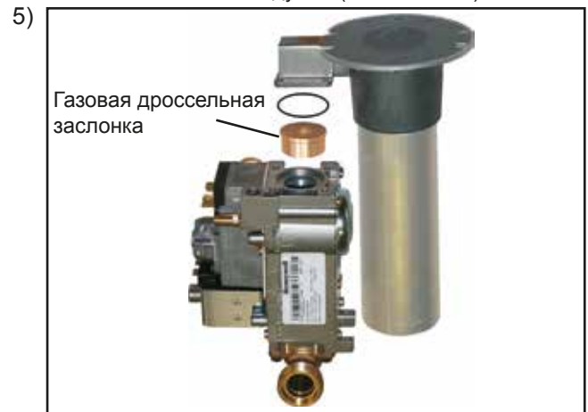
Извлечь установленную газовую дроссельную заслонку и заменить ее газовой дроссельной заслонкой, подходящей для нового типа газа (согласно таблице на стр. 25).
