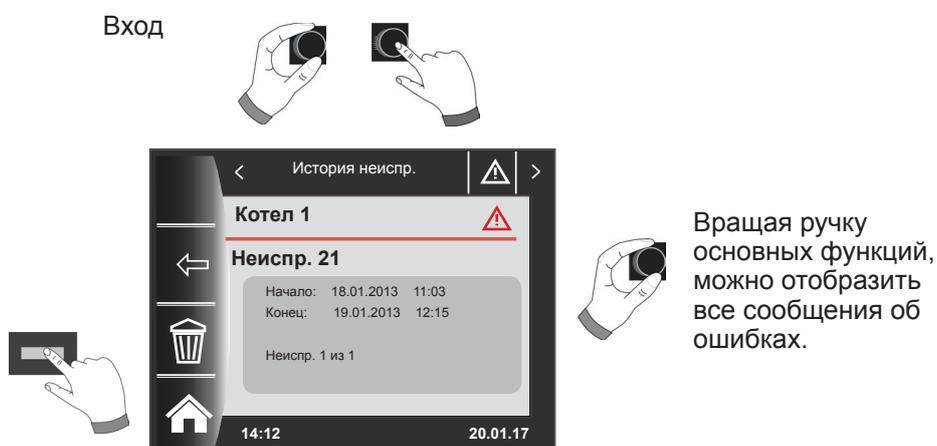
После завершения устранения неисправностей всю историю неисправностей можно удалить, нажав для этого кнопку «Корзина».
