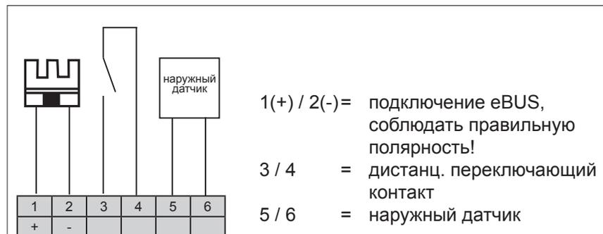
Рис. 4.8 Схема контактов клеммного блока настенного цоколя
