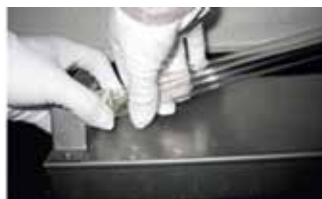
1. Ievietojiet UVC lampu aptverē
