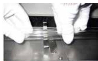
2. Introducir el tubo de luz UVC en el soporte delantero
