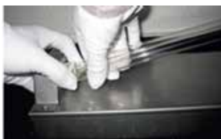
1. Лъчеви тръби UV-C – поставяне във фасунгата
