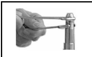
Рис.: Замена форсунки
