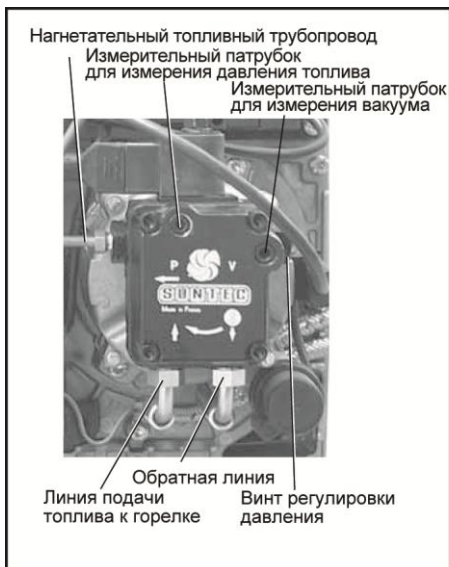
Рис.: Установка значения давления в топливном насосе
