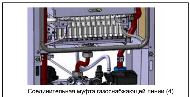
Рис.: Очистка газовой горелки
